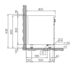
Electrical inlet (power) Equipotential screw
